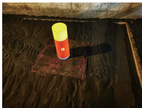
图 6 试验后的砂被防护单桩模型照片
