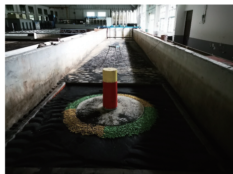
图 9 固化土防护在波流作用后照片(防护直径 1.33 m)
