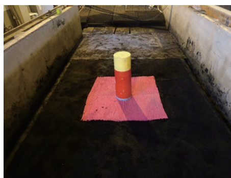
图 5 砂被铺设后的单桩模型照片
