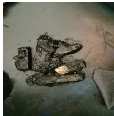
图 7 轴承保持架断裂碎片
