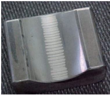
图 5 电腐蚀熔融痕迹(非现场图片)
