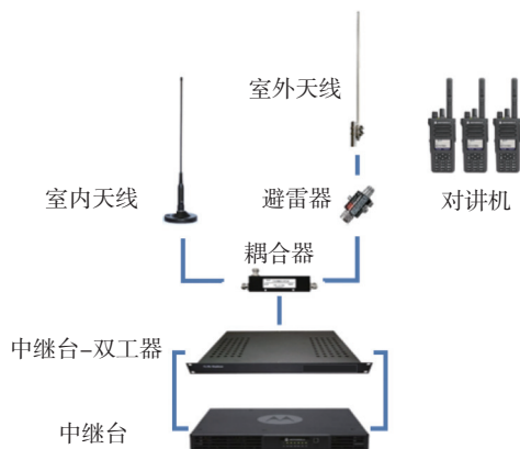
图 6 UHF 集群对讲系统组成示意图
