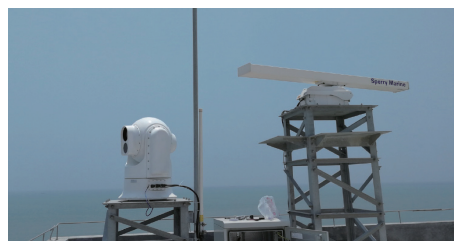
图4 雷达光电系统安装示意图
