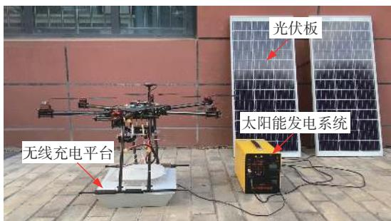
图 13 光伏发电一体无线充电平台
