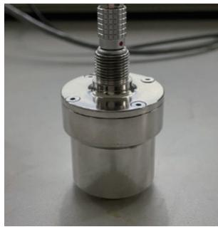
图4 电磁超声探头
