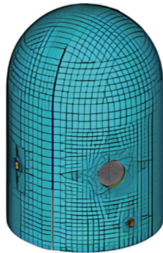
图 2 预应力混凝土安全壳有限元模型
