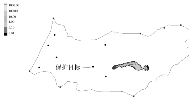
图2 某燃煤电厂柴油渗漏30年后的污染超标范围与最近保护目标位置关系图
