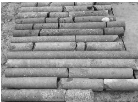
图4 注浆后钻芯试样
