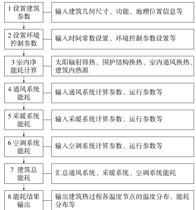
图2 PCES 计算流程图
