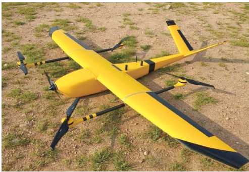
图1 航测中使用的混合垂直起降固定翼无人机
