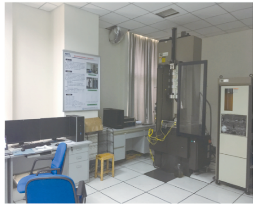
图 1 MTS 岩石三轴试验机
