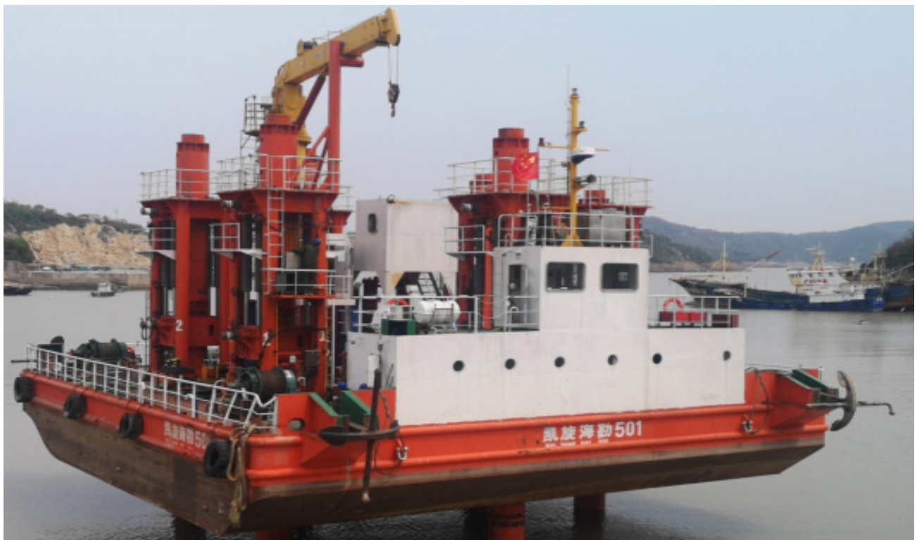
国内目前服务于海上风电工程勘探中最先进的自升式勘探平台之一“凯旋海勘501”
