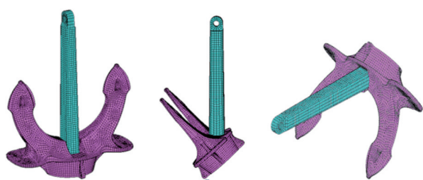
图1 霍尔锚三维立体有限元模型及网格
