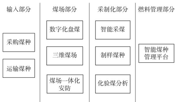
图1 智能燃料管理系统结构图
