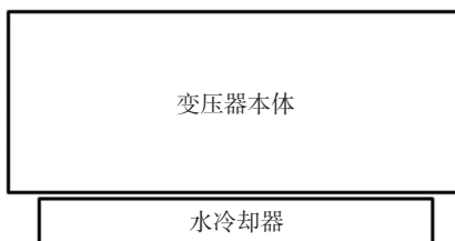
图 5 变压器采用 OFWF/ODWF 冷却方式的侧视图 Fig. 5 Side view of transformer cooled by OFWF/ODWF
