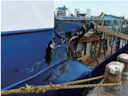
图4 “Raba”号货轮右舷严重受损 [10]
