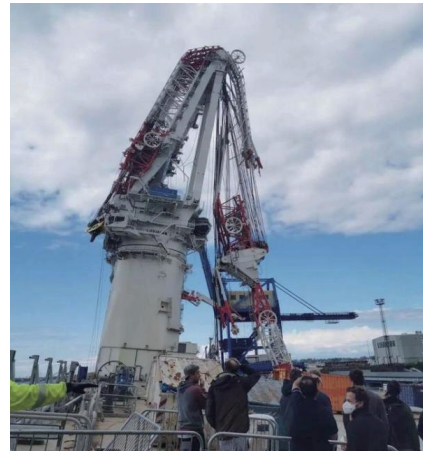
图6 吊臂折断的 Liebherr HLC 295000 起重机 [14]
