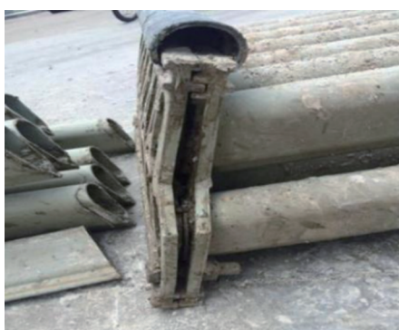
图5 管式除雾器下端板内积浆变形
