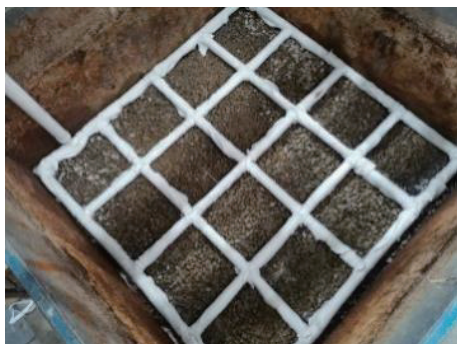
图2 土槽内部进排水系统
