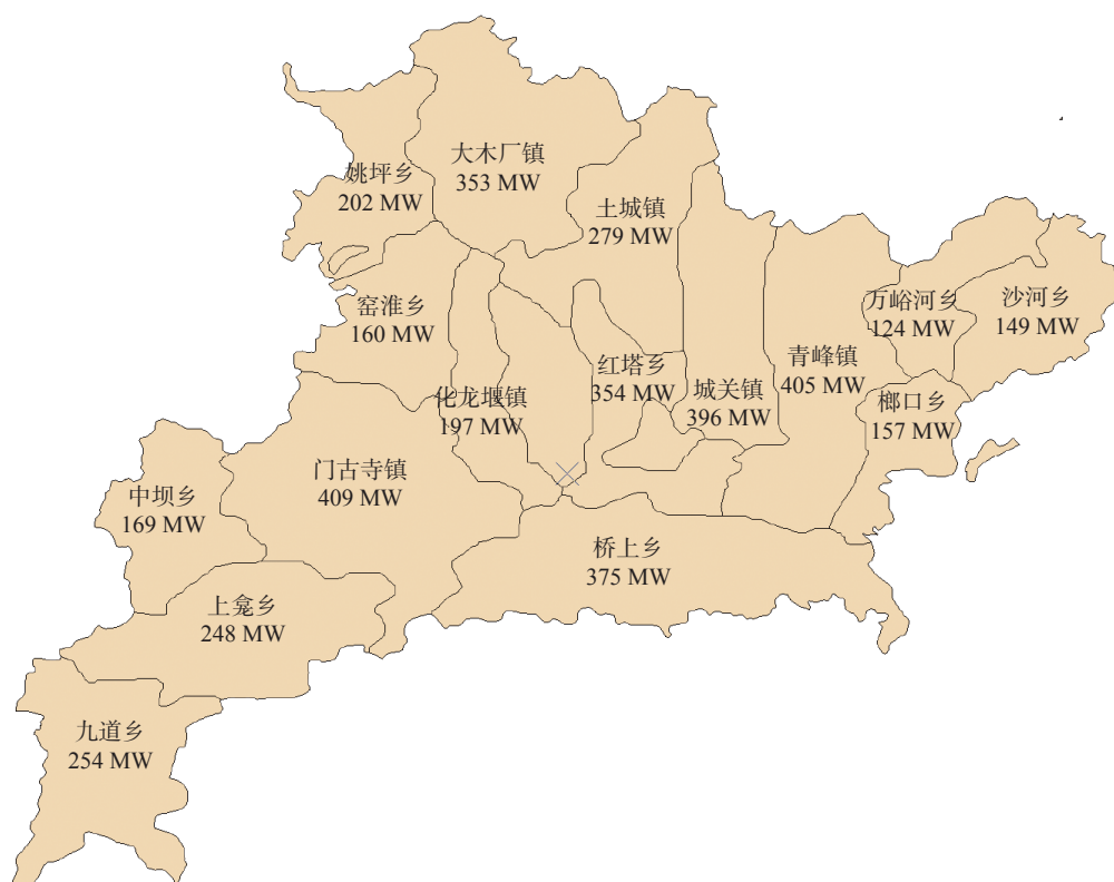
图 5 房县各乡镇光伏技术可开发量示意图
